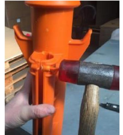
**5) Einen neuen orangenen Kunststoff-Stift einsetzen. Mit dem Gummi Hammer den Stift soweit hineinstossen, bis der Spalt wieder geschlossen ist. Der Federkopf ist wieder einsatzbereit.**
