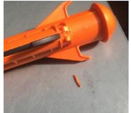
**1) Den orangen Kunststoff-Stift mit einem Gummi Hammer entfernen.**
