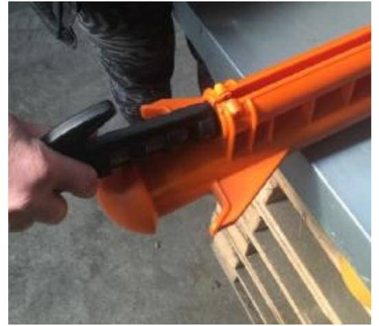
**4) Das neue Ersatzteil mit dem Haken nach oben wieder in den orangenen Kopf einführen.**
